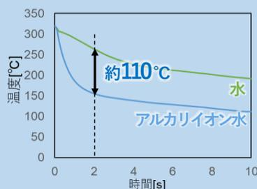
アルカリイオン水自体が高い冷却性を持ち、クーラントの冷却効果を引き上げる
