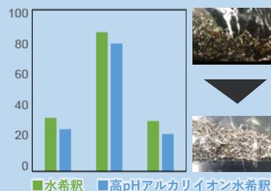
クーラントの水切れ性が向上し、ワークや切粉に付着した油剤の持出し量の削減が可能
